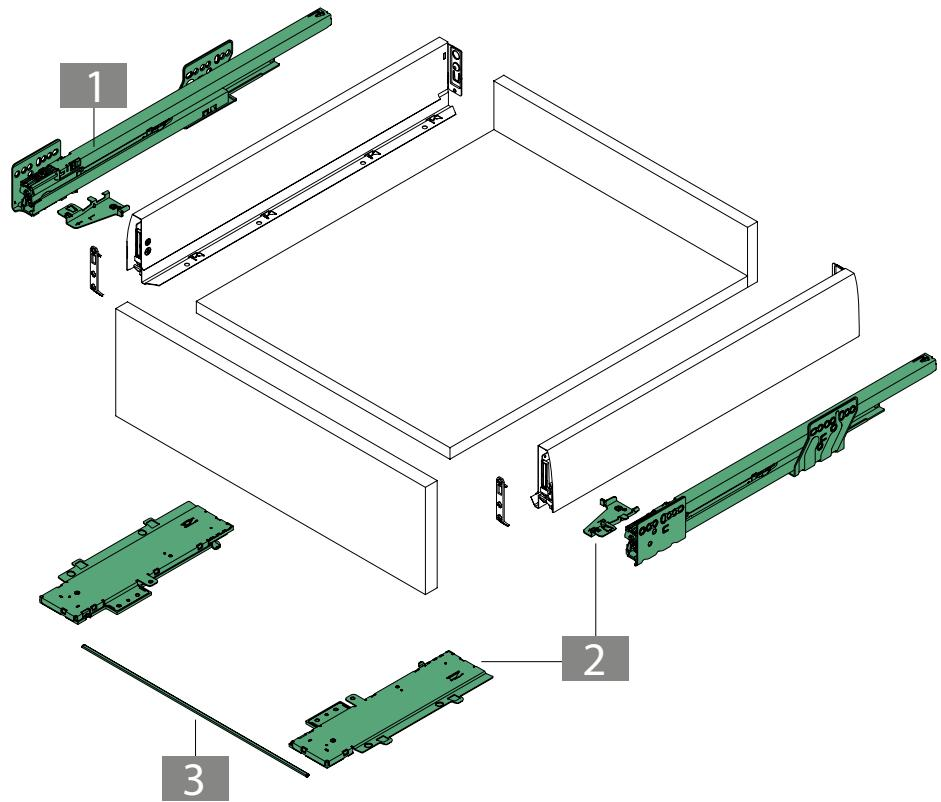
La différence d'installation entre la coulisse standard Nova Pro et la version TMSC est la distance minimale à partir du fond qui est 58 mm.
